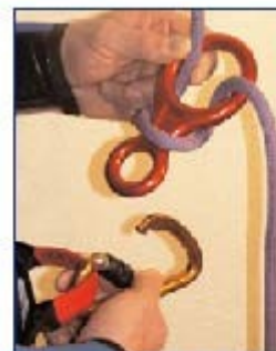
mise en place du descendeur
